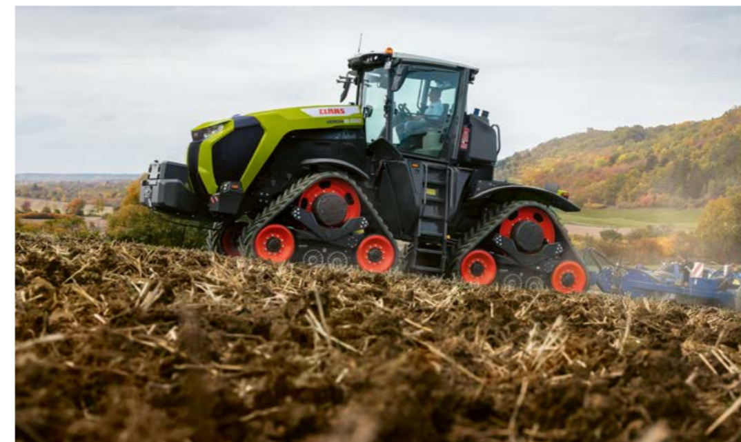
◀ El concepto de suspensión – empezando con el tren de rodaje de orugas con características de amortiguación, pasando por la suspensión de la cabina a 4 puntos, hasta el asiento premium amortiguado – ofrece en el XERION un confort de conducción especialmente alto.
